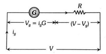
$$(I_o - I_G)R_A = I_GG \qquad V_0 = I_G(G + R_A)$$
